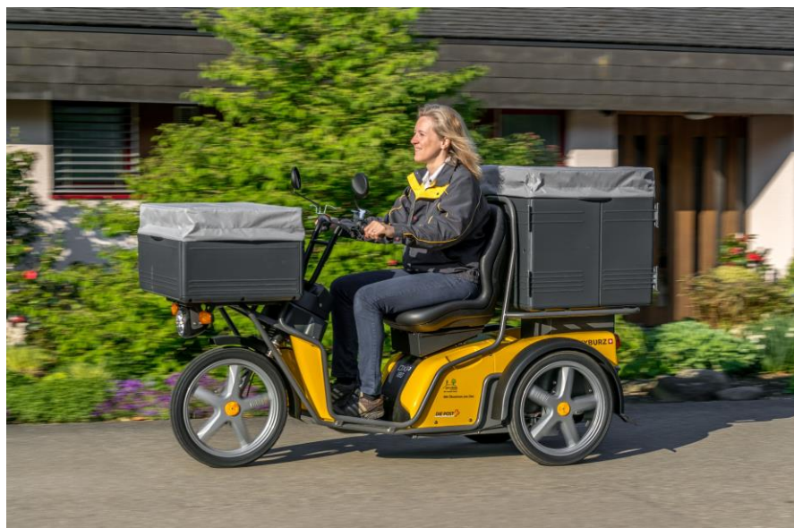
Der KYBURZ DXP hat sich als effizientes elektrisches Zustellfahrzeug bei der Schweizerischen Post bewährt. Als längstes DXP-Modell bietet der DXP 5 große Ladeflächen.
